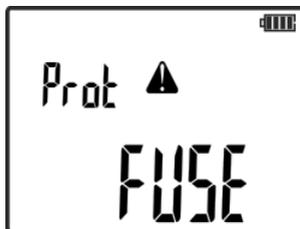
En este caso, pulsar el botón **START** para confirmar el uso del fusible electrónico y bajar el nivel de transmisión o utilizar el modo UI para trazar la línea eléctrica donde la corriente de transmisión forzada es fija y definida con el nivel de la señal.
